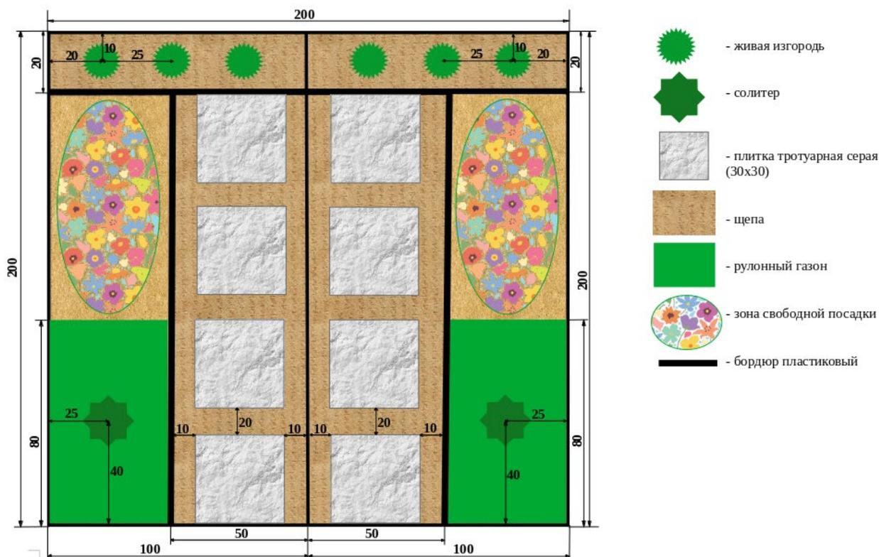
**Модуль 1 – Установка бордюра.** Определить разметку для установки бордюра, установить бордюр согласно схеме и закрепить металлическими колышками-фиксаторами (за основу берётся высота борта короба).
