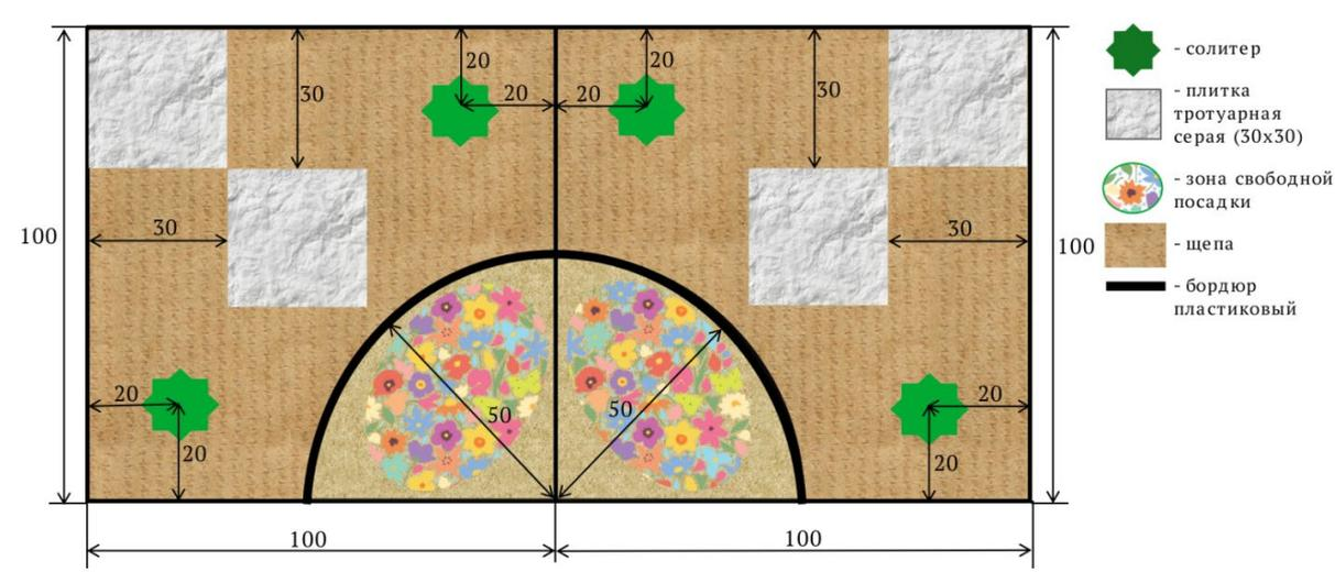
**Модуль 1 – Установка бордюра.** Определить разметку для установки бордюра, установить бордюр согласно схеме и закрепить металлическими кольшками-фиксаторами (за основу берётся высота борта короба).
